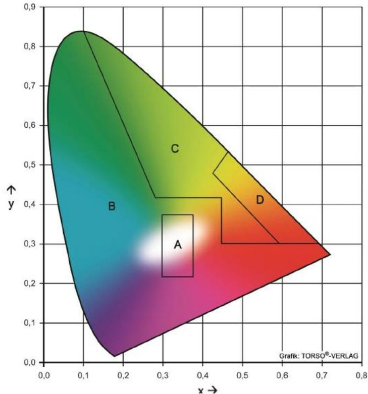
Abbildung 7: Farbschuh in Anlehnung an die Definition der DIN 6175-1
